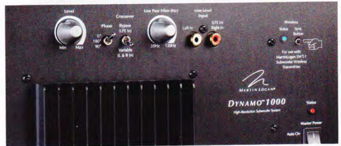
Regler für Pegel und Arbeitsfrequenz, Phasen-Schalter, nur NF-Eingänge, keine Anschlussmöglichkeit für Lautsprecherkabel
