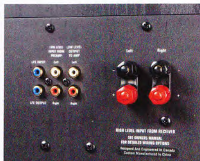
Der PSB kann hoch- und niederpegelig (Cinch) angesteuert werden
