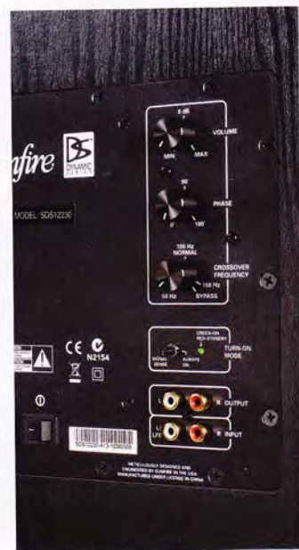
„Aktiv“ nach vorn, „passiv“ nach unten, das ist die Arbeitsteilung à la Sunfire. Ein Hochpegelanschluss per Boxenklemmen ist nicht vorgesehen
